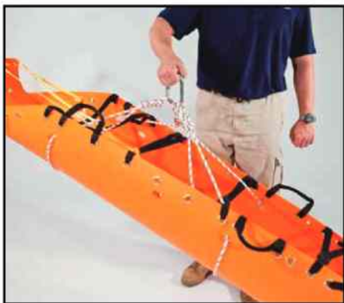
4. 為了病人的安全和舒適，頭部的繩子必須比腳部的短一些，這樣可以讓病人保持「頭略微向上」的姿勢。
