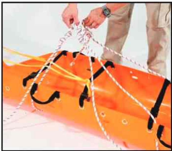
3. 在繩子的兩端打上8字結，讓繩子的末端從腳部的槽延伸出大約2.5英尺，頭部的繩子稍短一點。（參見第4步的照片）
