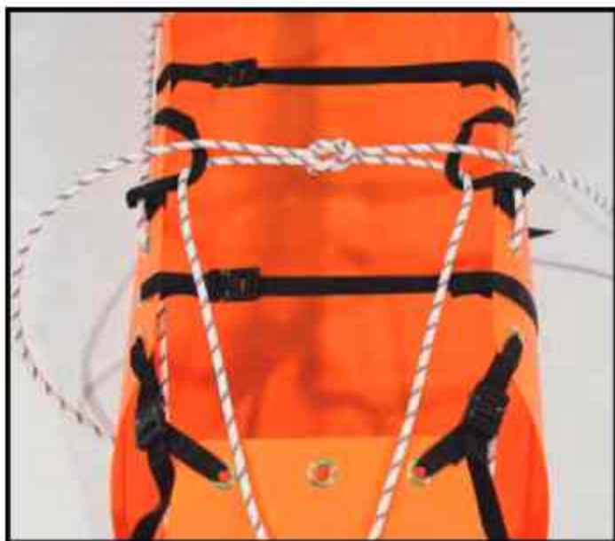
7.將繩子的末端從外向內穿過底部的提手，然後再打一次方形結。
