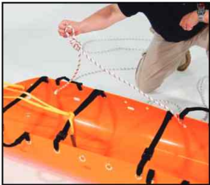
1. 抓住繩子中間已經打好的8字結，將繩子的兩端從內向外穿過斜角的升降吊帶槽。
